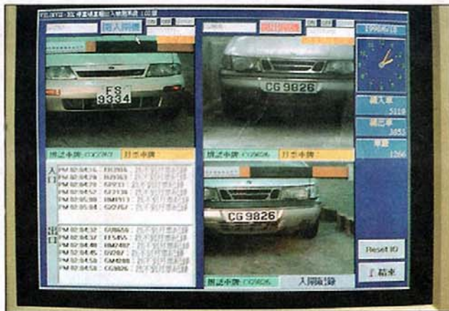
「慧光系統」能識別移動中貨櫃箱號碼及車牌號碼等。
