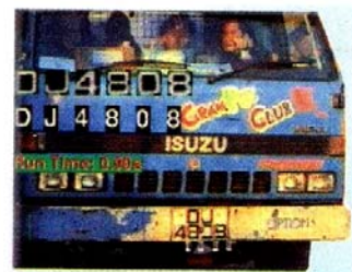
◆VECON 系統即使在惡劣環境如下雨、陰暗燈光，仍可閱讀壓印在靜止或正在行駛車輛之車牌和貨櫃上的字母號碼，直接改善貨櫃收發站操作效率，監察停車場車輛流量並加強保安管理。
